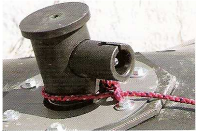
6 Der Feuerungsmechanismus wird eng in das Querstück geschraubt.
