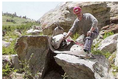
11 Das Resultat: Der Stein wurde erfolgreich mit dem Rock Cracker™ in mehrere Teile gespalten.
