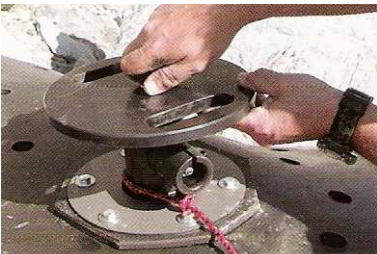
7 Eine Belastungsplatte wird auf den Feuerungsmechanismus geschraubt.
