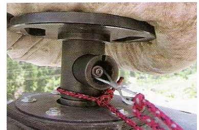
9 Ein Verbindungsstück wird mit beiden Kugeln an den Rock Cracker™ eingehängt.
