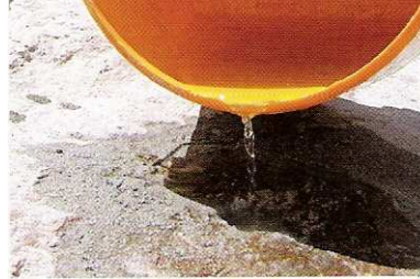
2 Das Loch wird nun mit Wasser gefüllt. Wenn der Stein porös ist, wird Gel zur Abdichtung benutzt.
