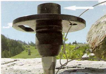
4 Das Querstück wird in das Loch eingefügt. Die weisse Marke oben (Pfeil) zeigt die Zugrichtung an.
