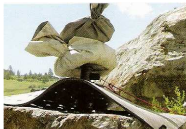
8 Der Rock Cracker™ wird mit Sandsäcken beschwert.
