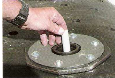
5 Die Sicherheitsmatte (1.4 x 1.4 m) wird in die richtige Lage gebracht und die Startpatrone wird in das Querstück eingeführt.
